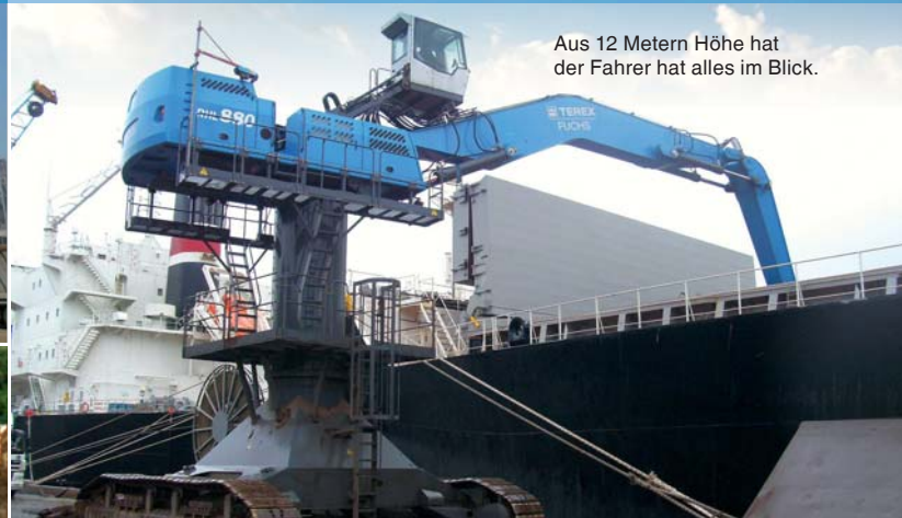
Schonend zum Untergrund: 800 mm breite Flachbodenplatten
